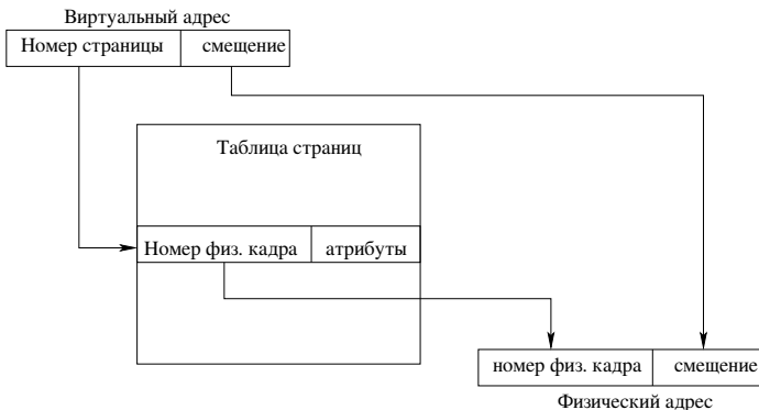
Рис. 8.7. Страничное преобразование адреса
