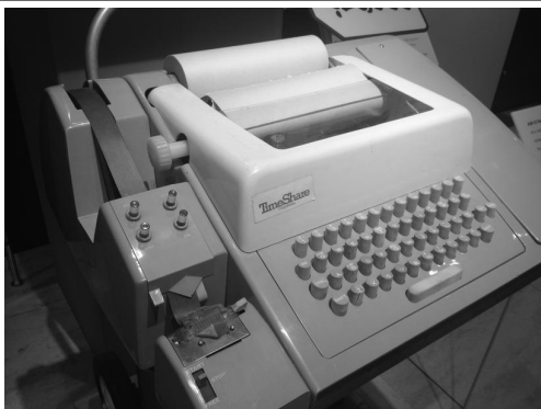
Рис. 1.4. Телетайп ASR-33 с перфоратором и устройством чтения перфолент 15
